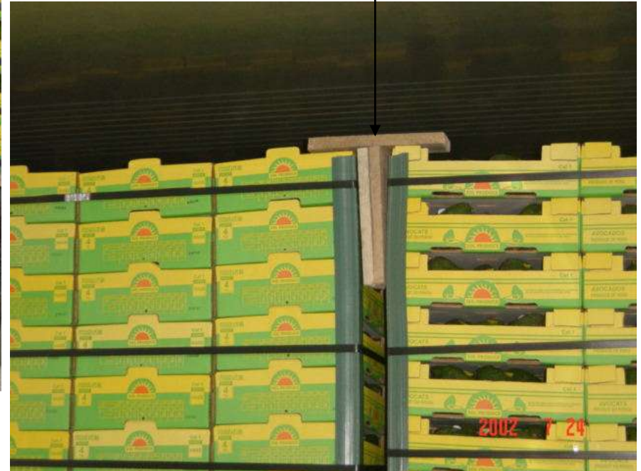
Cierre de pallets finales con “puente”
